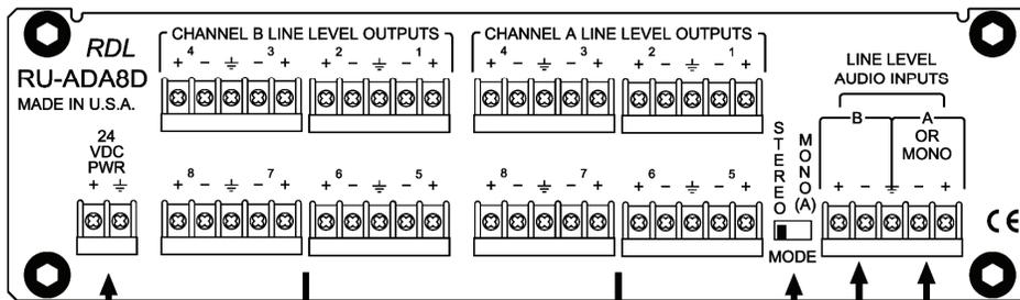
CONNECT 24 VDC POWER TO TERMINAL BLOCK
